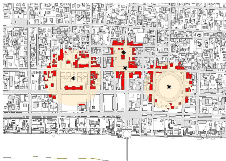
FIG. 1. ESEMPIO DI ELABORAZIONE IN GIS NELL'AREA DEL CENTRO STORICO PER L'ANALISI DELLA VULNERABILITÀ VISIVA. AL CENTRO DELLE PIAZZE I POV, IN ROSSO GLI EDIFICI INTERESSATI DAI CONI VISUALI.
